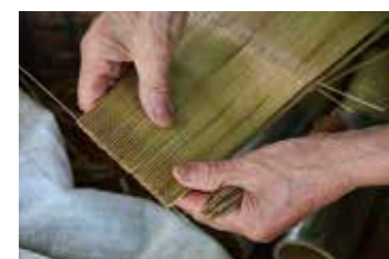
辻信夫さんは骨屋の4代目。小骨（支える部分）の寸法にカットした竹筒に、目印となる線を刻みつけてから薄く分割し、節に糸を通す穴を開ける。同じ竹から割いた骨を順番に配せば、傘を畳んだ時に元の竹の通りびったり納まる道理。材料の真竹は流水だと「性（しょう）が抜ける」ため、溜め池に浸しておく。
