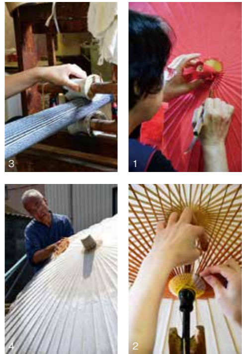
1/天上張り…小骨が集中する天部は、専用の道具で奥まで密着させてから、頂部に和紙を何重にも巻き重ねる。糊は、以前はわらび糊、現在はタピオカ糊が用いられる。 2/うるしを塗ったろくろと小骨をかがり糸でつなぐ。 3/碇子(がいし)に挟んでしごき、表面を滑らかにする。 4/仕上げに油をひき撥水性を高める。
