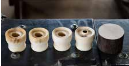
輪切りにされたエゴノキがろくろになっていく過程。
