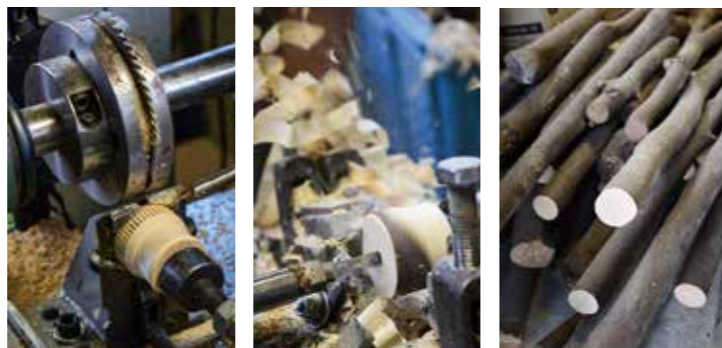
骨を束ねるろくろは、頭と手元のふたつで一組。番傘や蛇の目傘、さしかけなど用途により様々な大きさがある。材料のエゴノキは樹齢15~16年くらいが頃合いの太さ。中央に柄竹を通す穴を開け、外周に骨を納めるスリットと、糸を通す穴を斜めに入れる。
