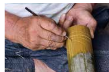
辻信夫さんは骨屋の4代目。小骨（支える部分）の寸法にカットした竹筒に、目印となる線を刻みつけてから薄く分割し、節に糸を通す穴を開ける。同じ竹から割いた骨を順番に配せば、傘を畳んだ時に元の竹の通りびったり納まる道理。材料の真竹は流水だと「性（しょう）が抜ける」ため、溜め池に浸しておく。
