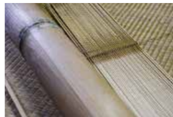
材料となる真竹と、割かれて節に穴が開けられた骨。
