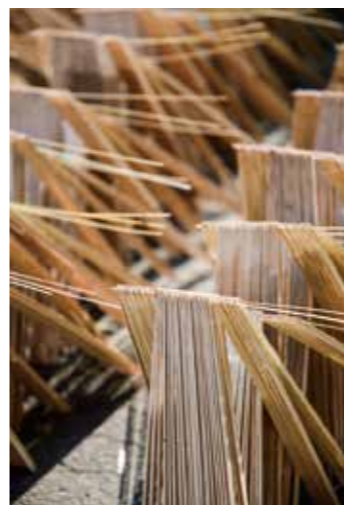
1本の竹からつくられた骨をユニットに組んで天日に干す。
