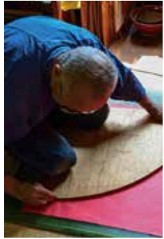
和紙を張るのは「張屋」の仕事。最も広い部分に相当する平紙は、扇形にカット(右)。親骨と小骨を糸でつなぐ(左)。
