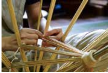
和紙を張るのは「張屋」の仕事。最も広い部分に相当する平紙は、扇形にカット(右)。親骨と小骨を糸でつなぐ(左)。
