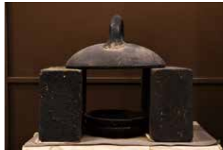
灯明を灯して、鍋の蓋のような部分に墨の原料となる油煙墨を採集する道具。
