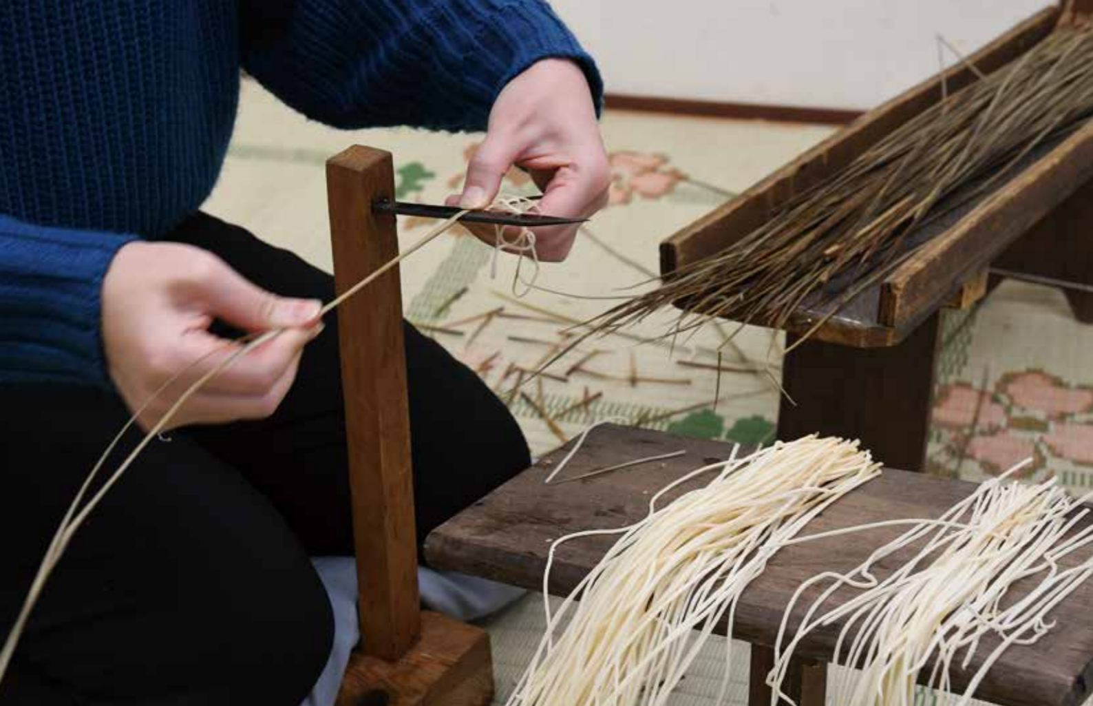
ひき台の刃で蘭草の外皮をひき裂き、乳白色のズイを取り出す。
